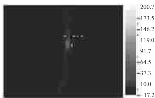
图 1 隔离开关 X 形连接处红外测温图谱
